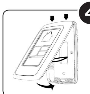
**4** FIXEZ LE MODULE AVANT SUR LA PLAQUE ARRIÈRE, EN INSÉRANT TOUT D'ABORD LA PARTIE SUPÉRIEURE DU MODULE AVANT DANS LES ATTACHES SUPÉRIEURES, PUIS EN PIVOTANT LE MODULE EN APPUYANT SUR LE BAS, JUSQU'À CE QUE VOUS ENTENDIEZ UN « CLIC ». VÉRIFIEZ QUE LE SYSTÈME DE VENTILATION FONCTIONNE.
