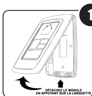
**1** DÉTACHEZ LE MODULE AVANT DE LA PLAQUE DE MONTAGE EN APPUYANT SUR LA LANGUETTE (SITUÉE AU BAS DU BOÎTIER).
