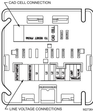
**Fig. 3. R7184 wiring connections.**
