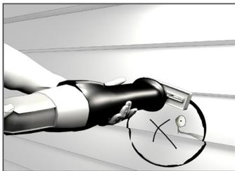
**1** Tracez le contour du collet de la hotte externe pour découper les trous d'aspiration et d'évacuation. Le diamètre des trous doit être un peu plus grand que celui du collet, pour tenir compte de l'épaisseur du conduit flexible isolé. Percez un trou pour la hotte d'aspiration et un trou pour la hotte d'échappement
