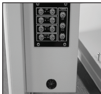
Figure 6 Insérez les fils du moteur du volet à travers la douille à travers la douille
