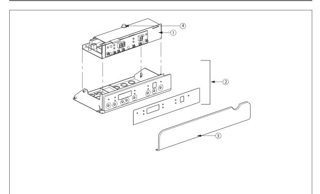
Fig. 33: CHALLENGER Control Components
