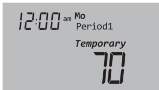
**NOTA:** para visualizar la temperatura del punto de ajuste, presionar una vez el botón **Arriba** o **Abajo**. Para modificar la temperatura del punto de ajuste, presionar cualquier botón más de una vez.
