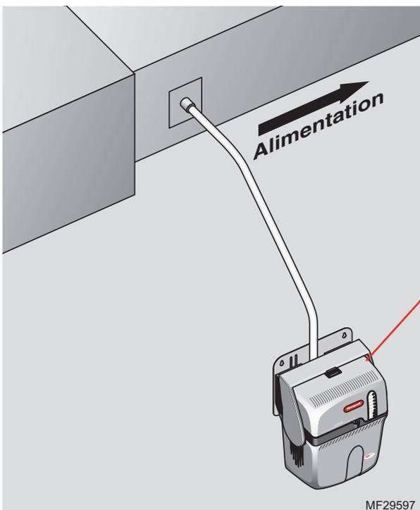
**Montage à distance.** Le système TrueSTEAM est installé à une certaine distance de la gaine d'alimentation de votre fournaise. Un tuyau isolé transporte la vapeur du système TrueSTEAM vers un emplacement approprié dans la gaine d'alimentation.
