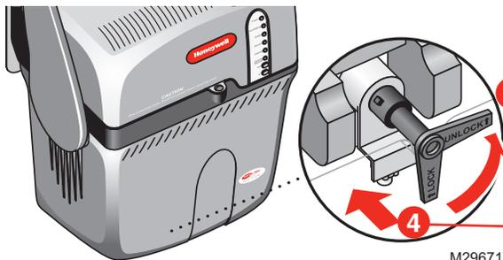
Tournez la vanne d'arrêt manuelle au bas du réservoir à la position « Unlock » (Déverrouiller).
