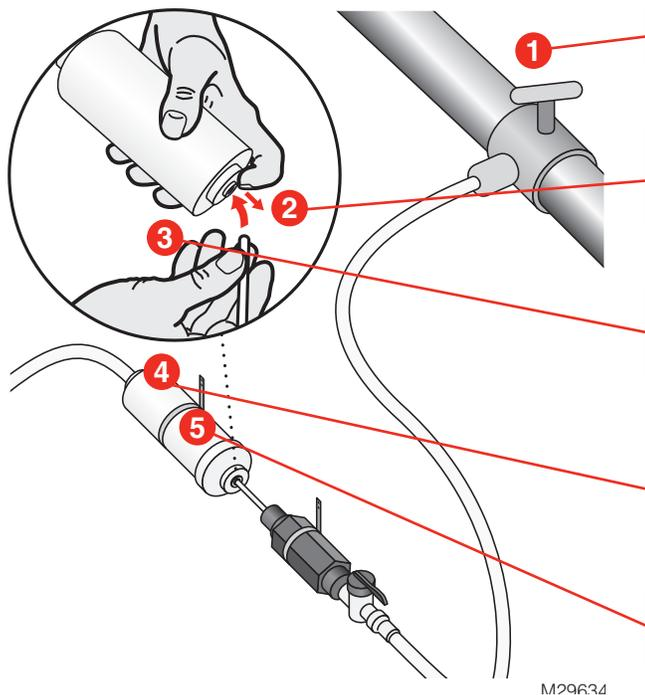
1 Coupez l'alimentation en eau à la vanne à étrier ou au raccord en T et à la vanne d'arrêt manuelle.
