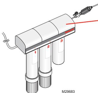
Filtre à osmose inversée (OI) avec dispositif anti-refoulement.
