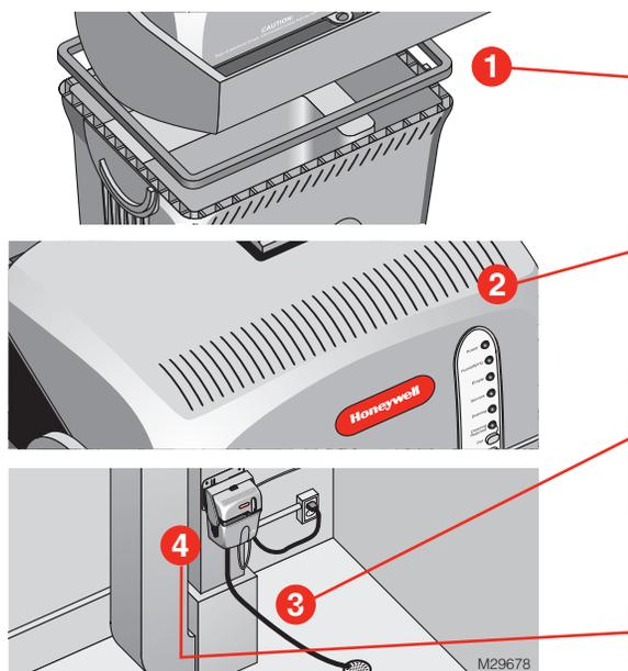
1 Inspectez le joint du réservoir d'eau. Si le joint est fendu ou fissuré, il doit être remplacé avant de le replacer sur le réservoir d'eau.
