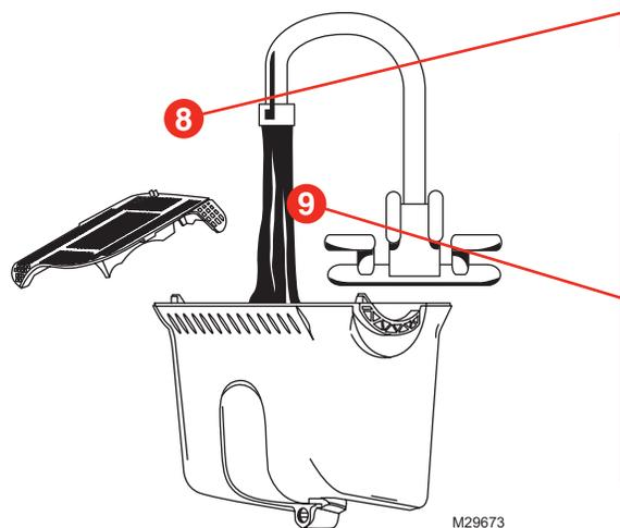
Déposez la crépine à sédiments du bas du réservoir.
