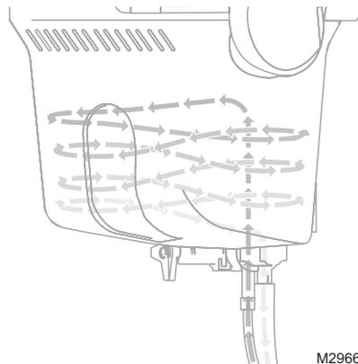
À la fin du cycle de vidange automatique, le système TrueSTEAM remplit le réservoir d'eau fraîche et retourne automatiquement au fonctionnement normal.
