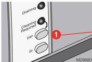
Appuyez sur le bouton Drain (Vidange) pour lancer un cycle de vidange et vider le réservoir d'eau. Le réservoir se vide si le voyant Draining (Vidange) clignote.
