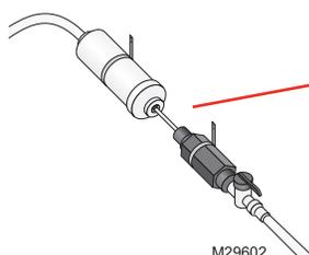
Filtre à eau en polyphosphate avec dispositif anti-refoulement.
