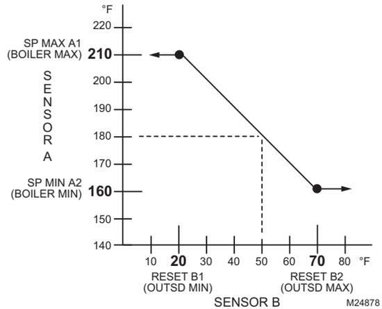
**Fig. 26. Reset Curve.**
