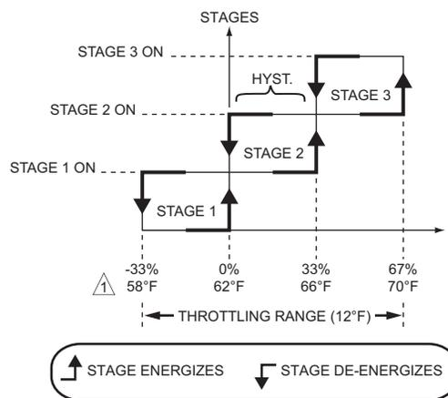
1 CHILLER DISCHARGE WATER TEMPERATURE M13895
