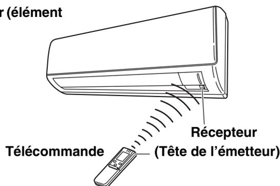
**Emplacement d'installation de la télécommande** La télécommande pourra être utilisée en position mobile ou en position fixe (montage mural). Pour garantir un bon fonctionnement du climatiseur, NE PAS installer la télécommande dans les endroits suivants :
