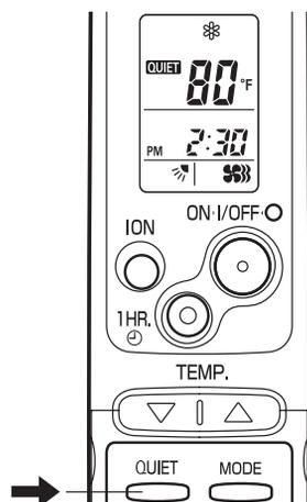
Le mode de silencieux (QUIET) est utilisé pour réduire le son du ventilateur de l'appareil.
