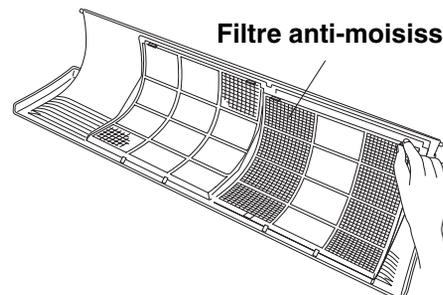
**Nettoyage** Se servir d'un aspirateur pour enlever la poussière légère. Si de la poussière adhère au filtre, laver celui-ci dans de l'eau tiède et savonneuse, puis le rincer dans de l'eau propre et le sécher.
