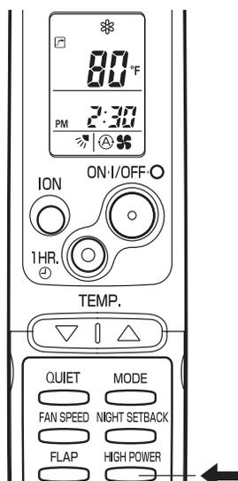
Le mode de fonctionnement à haute puissance (HIGH POWER) peut être utilisé pour augmenter la sortie de l'élément intérieur pour tous les modes de fonctionnement.
