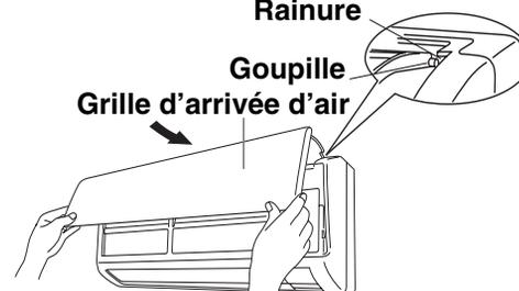
3. Appuyer sur les coins inférieurs droit et gauche de la grille d'arrivée d'air pour l'attacher à l'appareil.
