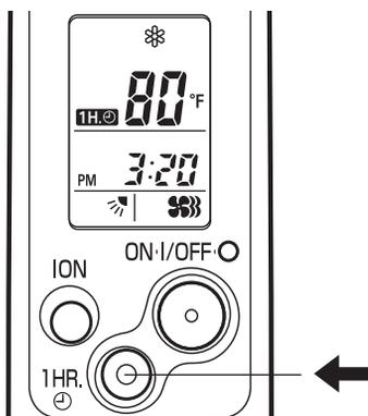
Cette fonction fait en sorte que l'appareil fonctionne pendant une heure, puis qu'il s'arrête indépendamment qu'il soit en service ou hors service au moment où le bouton est actionné.
